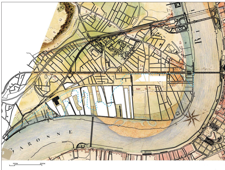
Fig. 9. Superposition du PPRI (Plan de prévention du risque inondation) et du projet sur le plan de Didier ( Plan général du projet d’un pont à établir sur la Garonne devant Bordeaux ; Didier ing., 1809, AM Bordeaux, Fi 40 A287 23 PP01).
